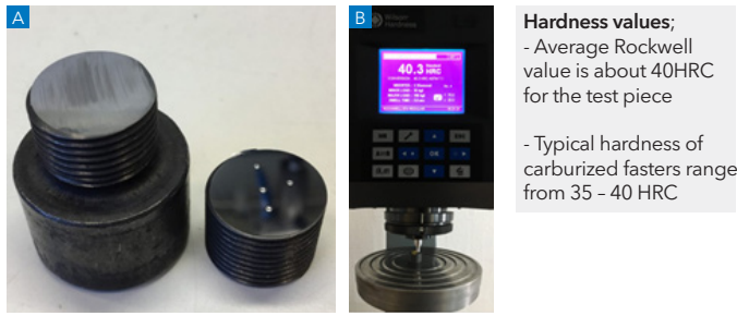
Figure 4. (c) test piece and indentation points, (d) Rockwell 574
