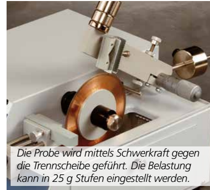
Eine breite Palette an unterschiedlichen Probenhaltern ermöglicht das einfache Spannen der Probe.
