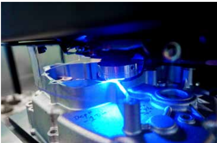
Härteprüfung an einem AlMgSi-Gussteil mit Wilson UH4750
