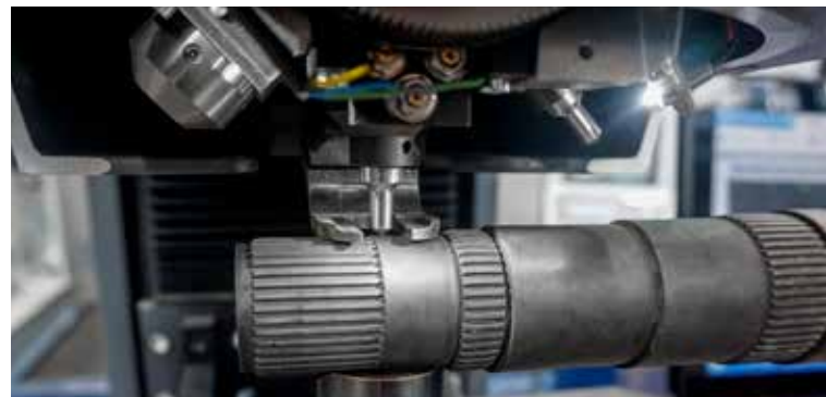
Um einen unkomplizierten Zugang für Teile mit komplexerer Geometrie zu ermöglichen, kann die Sicherheitsabdeckung abgenommen werden.
