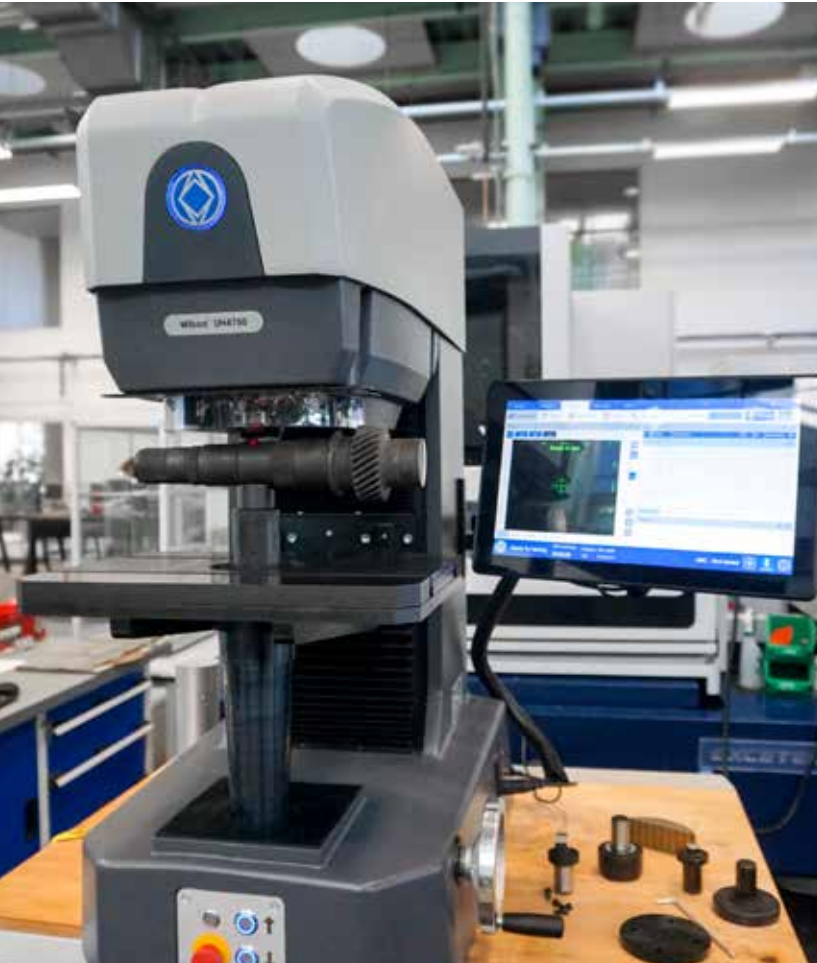
Das UH4000 kann mit einer Druckstempelverlängerung zur Prüfung kleiner oder zylindrischer Teile ausgestattet werden.
