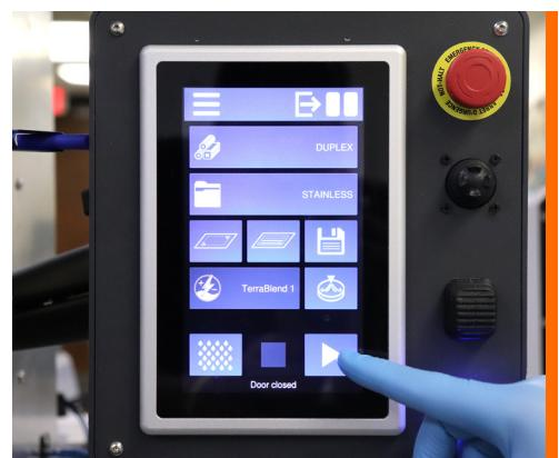
Für eine einfache Reinigung bietet **NeoTerra** sowohl automatische als auch manuelle Reinigungsoptionen. Eine automatische Reinigung wird nach einem benutzerdefinierten Zeitraum der Inaktivität ausgelöst. Die manuelle Reinigung ist jederzeit auf Knopfdruck verfügbar.
