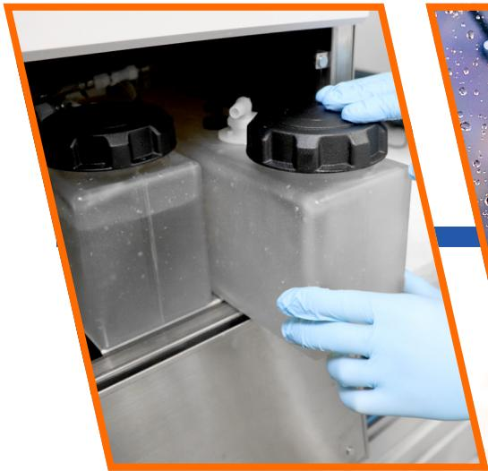
Die 2 verfügbaren Tanks enthalten jeweils eines der TerraBlends, welche im internen Kreislauf zirkulieren um die Proben zu präparieren. So können mehrere Proben mit einer Einheit TerraBlend präpariert werden. Die Lebensdaueranzeige der Elektrolyte ist vom Benutzer individuell anpassbar, um die Lebensdauer der TerraBlends zu maximieren und die Wartung zu vereinfachen.
