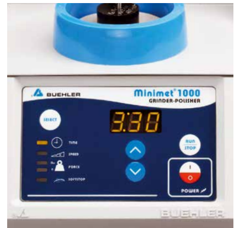
Bedienfeld mit Folientastatur und LED-Anzeige für die Präparationsparameter.
