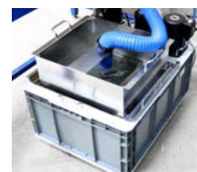
Bac de recirculation/filtration
