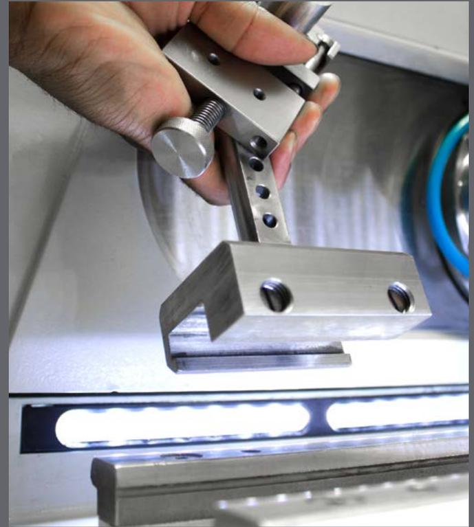
Le système Rapid Rail de Buehler permet aux utilisateurs de sécuriser les échantillons dans la chambre de coupe et de commencer la coupe suivante en quelques secondes.
