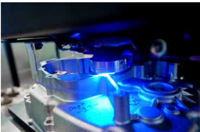
Modèle Wilson UH4750 avec pièce de fonderie en AlMgSi
