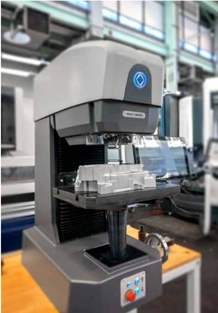
Modèle Wilson UH4750 avec pièce de fonderie en AlMgSi
