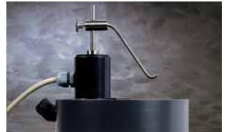
L'échantillon repose directement sur la partie supérieure de la cellule, il est ensuite relié à l'anode. Dessous, les masques sont très facilement interchangeables permettant le polissage de surfaces variables.
