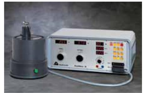
Le PoliMat 2 est composé de 2 éléments, le boîtier de contrôle et la cellule d'électrolyse. Le boîtier de contrôle est robuste et très fiable, des écrans LED et des boutons poussoirs traditionnels ont été préférés aux écrans LCD électroniques. Les paramètres de polissage et d'attaque peuvent être réglés séparément.
